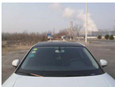
图 4 GNSS 天线安装
