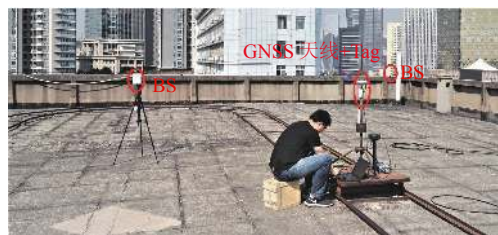
图 3 楼顶滑轨推车动态实验部分现场
